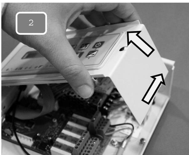
En las centrales del Mod. DURPARK MINI, deberá retirar el conector de la fuente de alimentación, lo que le permitirá abatir completamente el panel.
