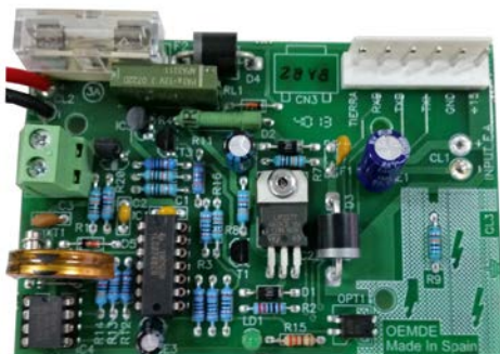
Módulo controlo alimentação
