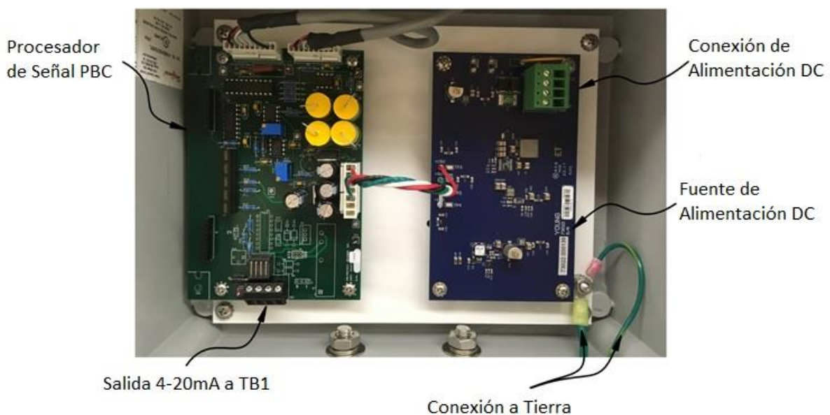
Figura 1.3-2 Componentes de la caja principal (versión alimentación DC)
