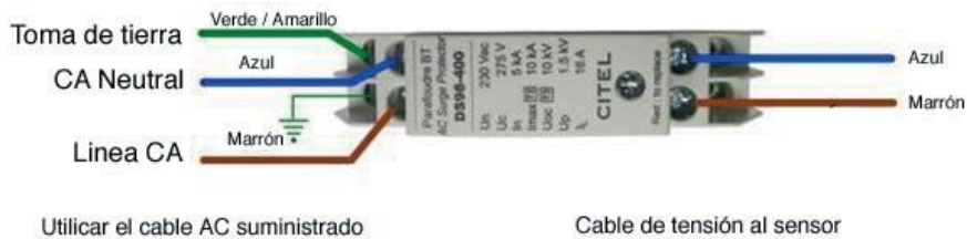
Figura 5.4.4-1 Cableado del módulo de protección contra sobretensiones
