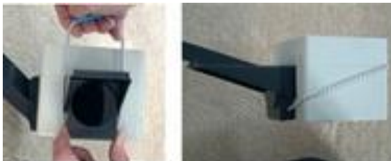
Fig. 4.1-2 Instalación del filtro ND 4
