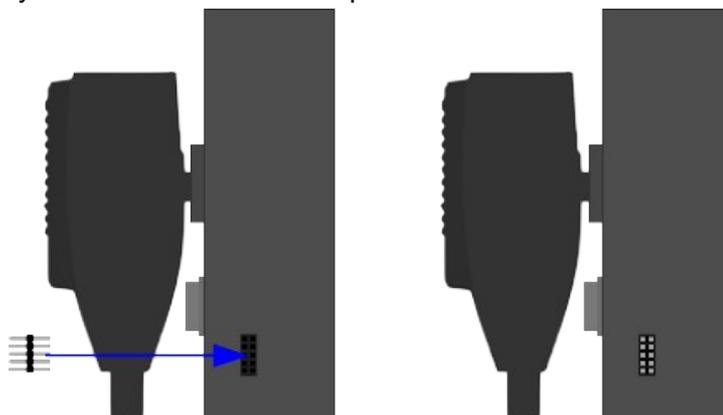
Ilustración 11: Conexión Teclado Expansión. Paso 1 Adaptador
