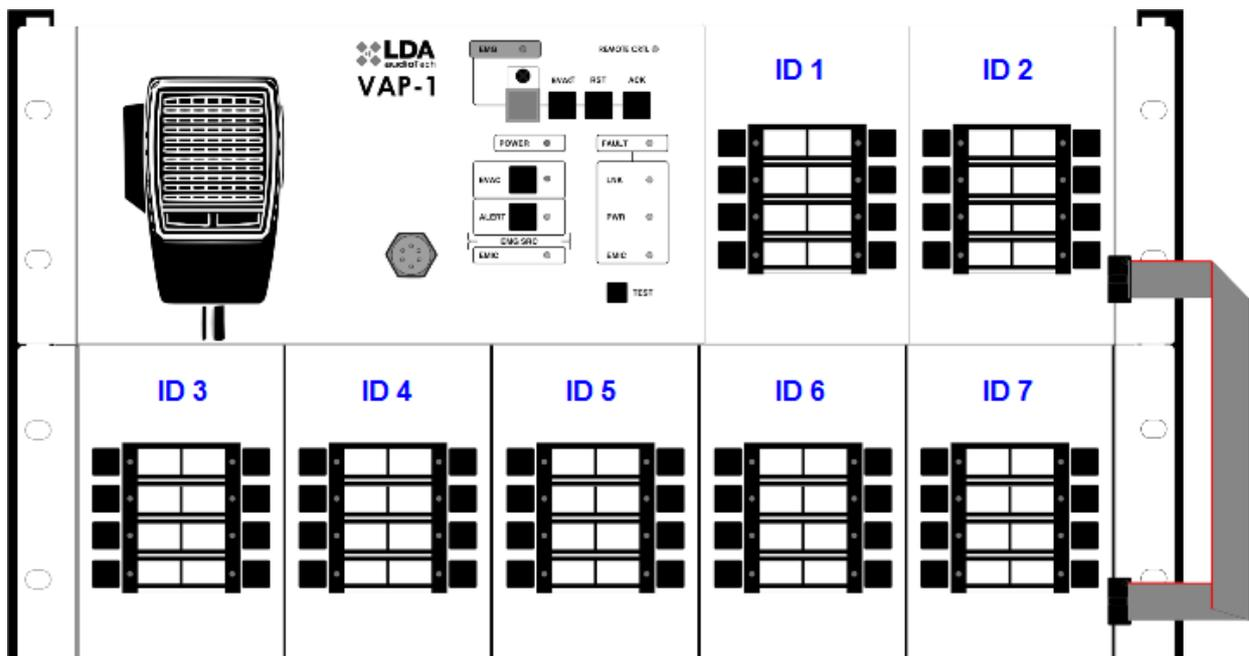
Ilustración 16: Conexión Teclados Extensión. Montaje en Rack
