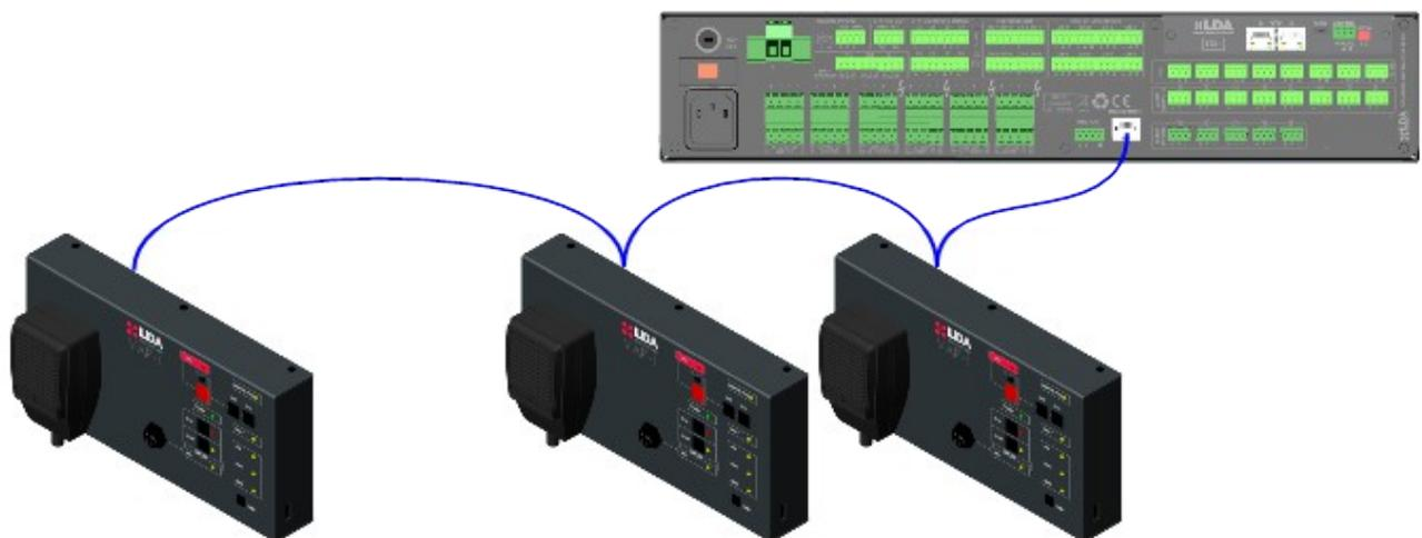
*Ilustración 9: Conexión al Sistema de Evacuación por Voz*
